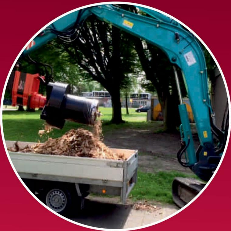
*Cette nouvelle série des foreuses de souches d'arbres avec récupérateur de copeaux a été développée pour éliminer des souches d'arbres et de récupération des copeaux en même temps, après quoi d'être vidanger facilement. Avec le R-Top® SC on travaille efficacement, commodément et durable. Le R-Top® SC est disponible en plusieurs versions aux diamètres de la mèche; 50, 60 ou 80 cm. Récupération facile des copeaux comme matière première de compostage.*
